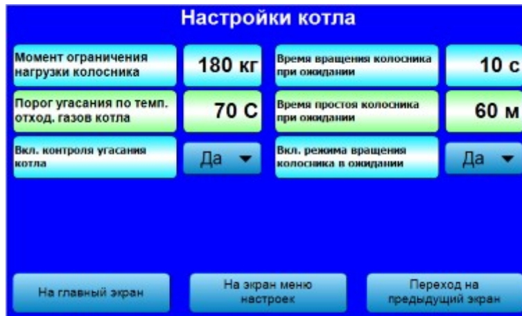
Рис 6.7. Экран настроек котла
