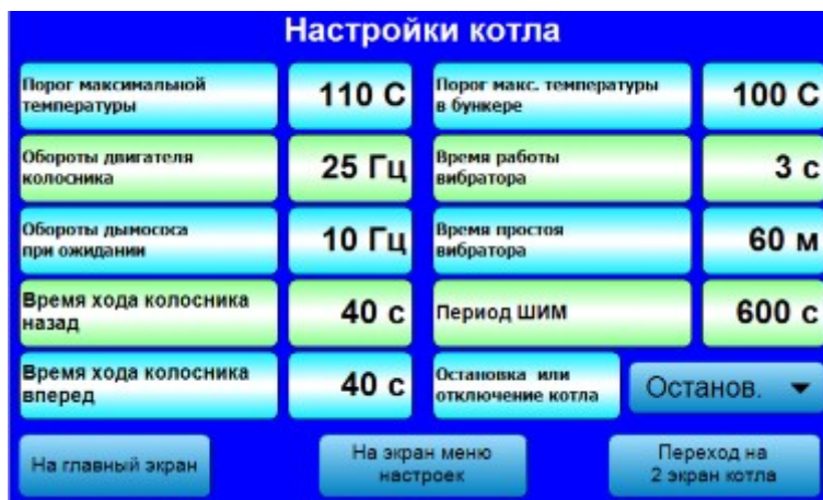
Рис 6. Экран настроек котла.
