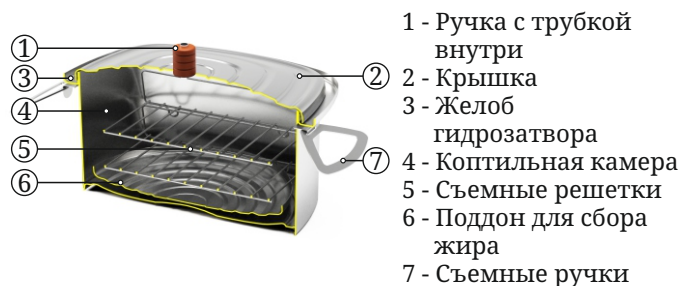
Рисунок 2. Общий вид и основные элементы коптильни
