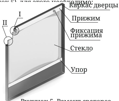
Рисунок 5. Ремонт светорозрачного экрана дверцы
