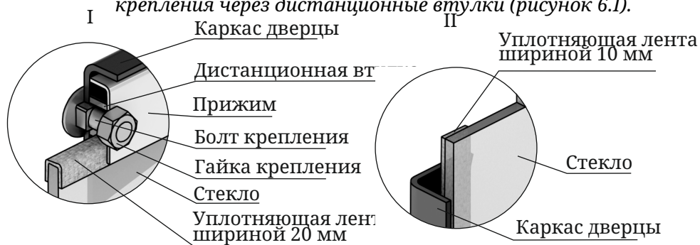
Рисунок 6. Крепление светорозрачного экрана дверцы
