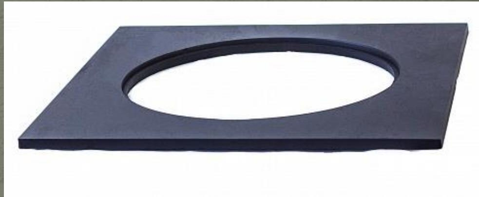
Плита металлическая казанная предназначена для установки на казан-мангал. Это запатентованная технология завода "НМК". Она изготовлена из стали Ст3 СП5 толщиной 12 мм, что делает ее долговечной, надежной и износостойкой. Масса плиты составляет 18,3 кг, габаритные размеры - 500 мм x 500 мм.
