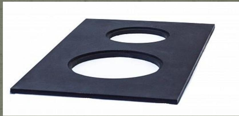
Она изготовлена из стали Ст3 СП5 толщиной 12 мм, что делает ее долговечной, надежной и износостойкой. Она предназначена для установки на котлы серии "Сибирь КВО", а также на печи, выполненные из кирпича в которых произошла деформация варочной поверхности. **Масса плиты составляет 23 кг, габаритные размеры - 400 мм x 700 мм.**
