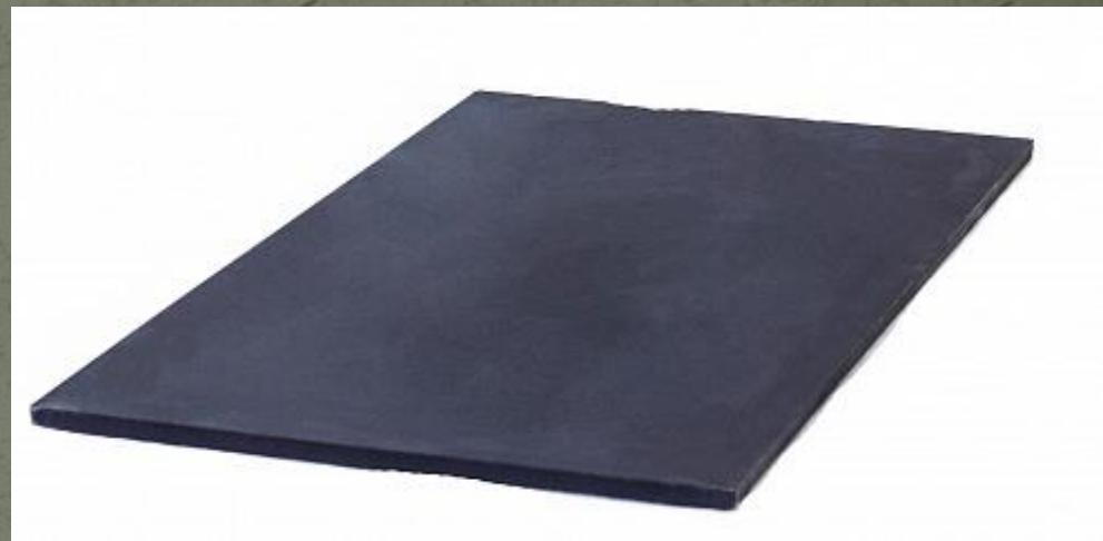
Она изготовлена из стали Ст3 СП5 толщиной 12 мм, что делает ее долговечной, надежной и износостойкой. Она предназначена для установки на котлы серии "Сибирь КВО", а также на печи, выполненные из кирпича в которых произошла деформация варочной поверхности. Масса плиты составляет 26 кг, габаритные размеры - 400 мм x 700 мм.
