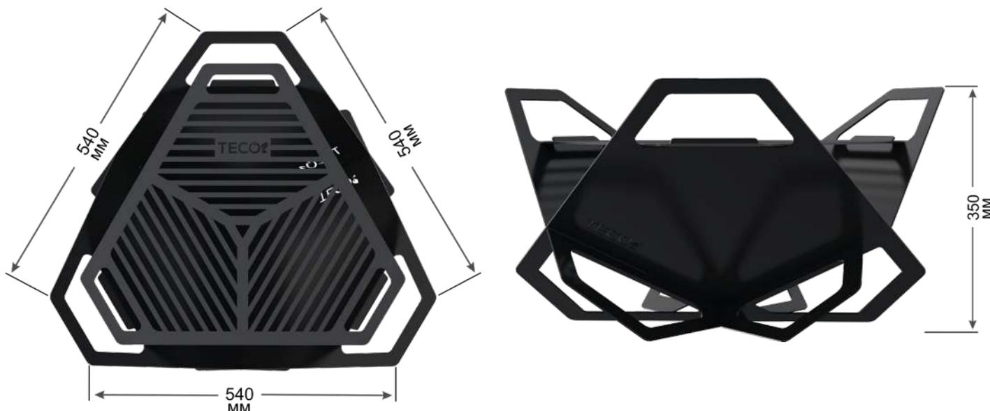
Рис. 3 Габаритные размеры костровой чаши – гриль в сборе
