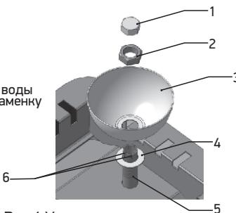
Для сборки узла для подачи воды в печь-каменку, закрутите контргайку(4), установите чашу (3) на контргайку, зафиксируйте её гайкой (2). Заглушка (1) предназначена для регулирования подачи воды в закрытую каменку.
